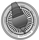
Figure 9 : Réglages de la vanne pour le démarrage. Arrêter la pompe avant de changer la position de la vanne.
