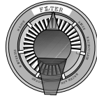
Figure 9 : Réglages de la vanne pour le démarrage. Arrêter la pompe avant de changer la position de la vanne.
