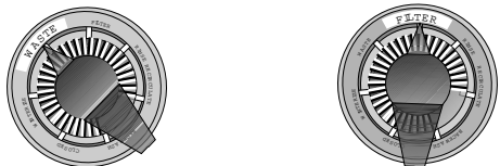
Figure 10 : Réglages de la vanne pour abaisser le niveau de l'eau dans la piscine. Arrêter la pompe avant de changer la position de la vanne.
