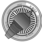
Figure 9 : Réglages de la vanne pour le démarrage. Arrêter la pompe avant de changer la position de la vanne.
