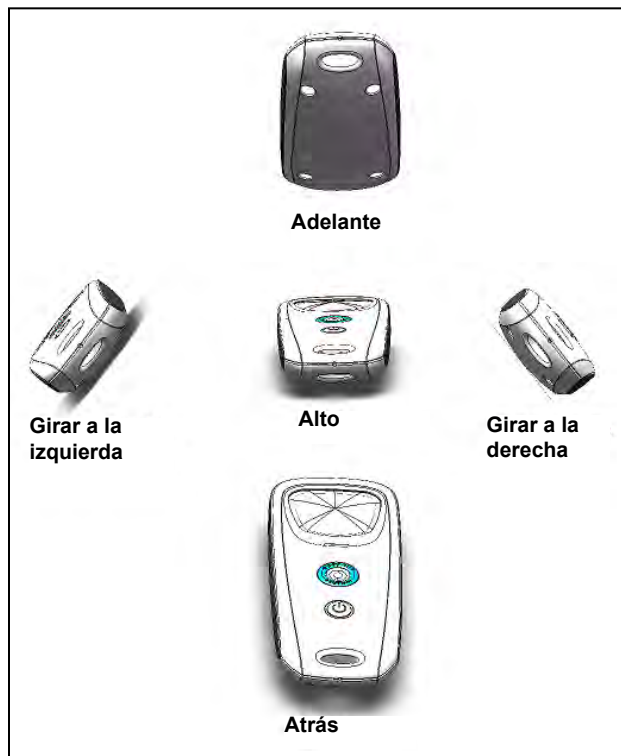
Figura 21. Comandos direccionales del control remoto
